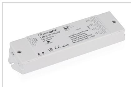
Контроллер для светодиодной ленты RGBW (ШИМ). Питание/рабочее напряжение DC 12–36 В, максимальный ток 5 А на канал, 4 канала, максимальная мощность 240–480 Вт. Винтовые клеммы. Корпус PVC. Размеры 178×46×18 мм. Управляется пультами и панелями серии SR-1009x (поставляются отдельно). Аналогичные номиналам и функционалу устройства представлены в серии SMART (устройства не совместимы).
